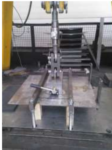
Figuur 3: testopstelling voor de bepaling van de losbreekkraft
